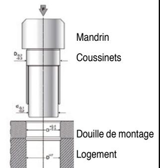
**Lors de l'assemblage vérifier la propreté du logement comme de l'arbre.**
