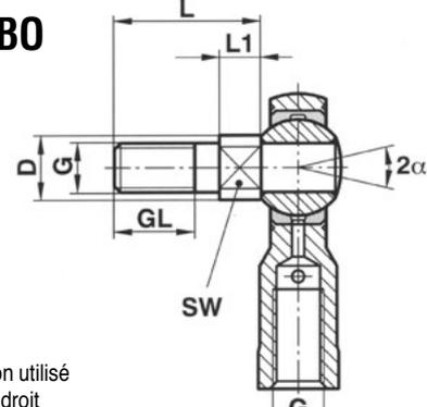
Tête de bielle avec goujon utilisé pour connexion et angle droit
